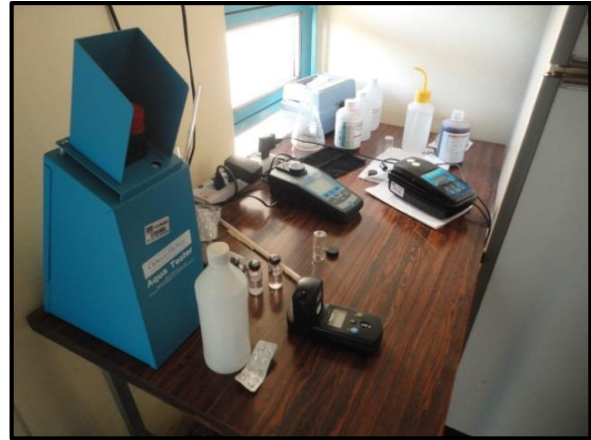
Figura 21. Equipamentos utilizados diariamente no monitoramento da qualidade da água distribuída.
